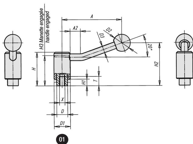
01 Version avec taraudage intérieur / with inside thread
